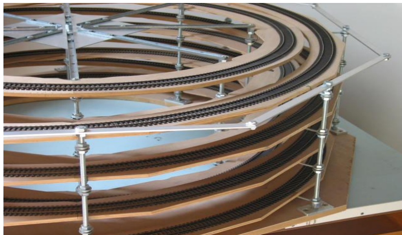
Abb. 5: Die äußere Aussteifung bei dieser Auf-Ab-Wendel wurde durch sog. Außenverbinder hergestellt. innere und äußere Wendel sind bis auf die im Fußpunkt eingebaute Verbindung voneinander unabhängig.
